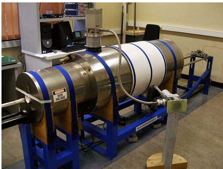
Figuur 1.28. Cryogene magnetometer van "2G Enterprises" geïnstalleerd in het Geofysisch Centrum van het KMI na nazicht. Nieuwe ontvangers (SQUIDS DC) verhogen de gevoeligheid. Een 4K cryogenerator (op de afbeelding: de hexagonale verticaal geplaatste opstelling) koelt de detectoren en ontvangers af, waarbij de overtollige vloeibare helium terug afgevoerd wordt.
