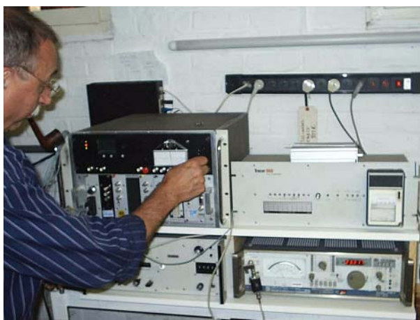
Figuur 1.27. Een opstelling voor specifieke bemonstering van de D laag van de ionosfeer: prototype van de elektronische console.
